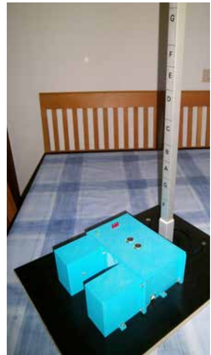
Abb. 1: Das fertige Instrument bestehend aus einem Gehäuse, in dem die Sensoren und die Elektronik untergebracht sind, und einer Stange mit einer Notenskala.
