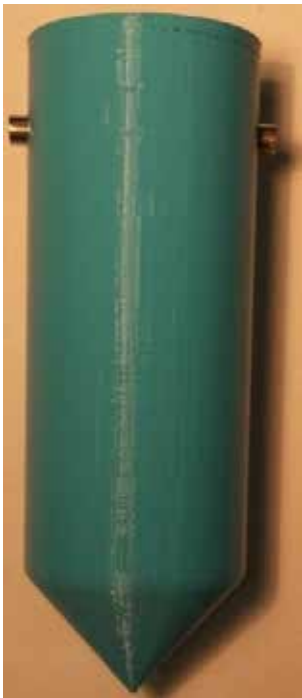
Abb. 11: Probengefäßhalterung aus dem 3D-Drucker.
