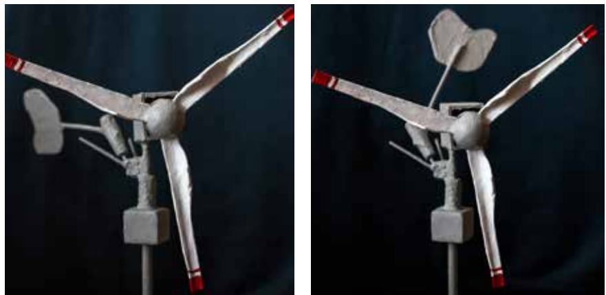
Abb. 8: Die Segelposition bei niedrigen Windgeschwindigkeiten (links) und bei hohen Geschwindigkeiten (rechts).
