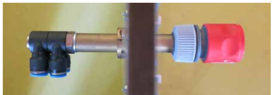
Abb. 10: Übergangsstück Festo und Gardena Komponenten die nicht kompatibel sind.
