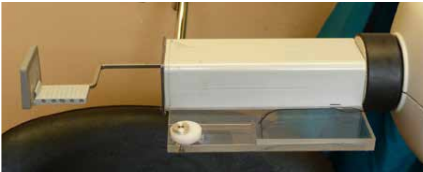
Abb. 9: Panoramaansicht der gesamten Röntgenanlage mit modifiziertem Tubus samt Blende und eingespanntem Filmhalter.
