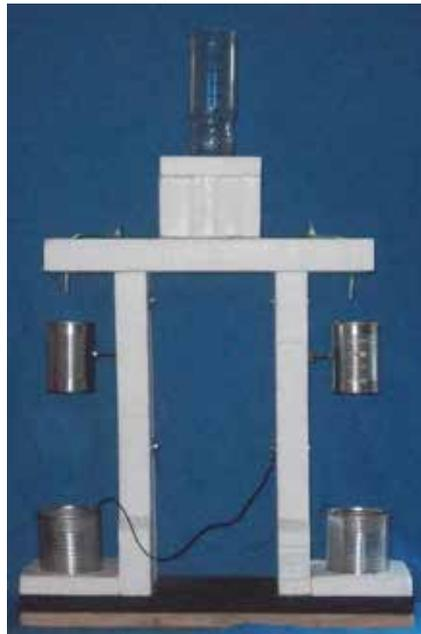
Abb. 1: Der für diese Arbeit gebaute Kelvingenerator.
