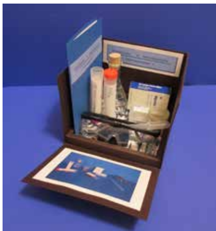
Abb. 12: Prototyp eines Experimentierkastens zur dendritischen Kristallisation von Salzen.
