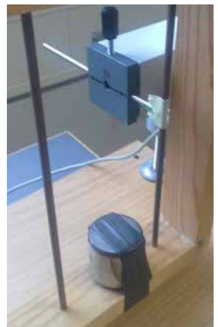
Abb. 10: Befestigung des Kraftmessers.
