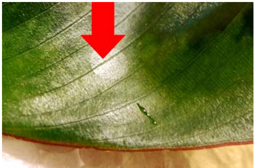
Abb. 6: Entfernen der Wachsschicht mit Klebstoff: Der Klebstoff wird aufgetragen und trocknet (oben). Nach dem Entfernen ist die entwachste Stelle sichtbar (siehe Pfeil unten).
