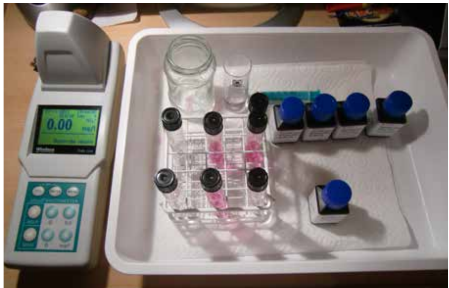
Abb. 3: Versuchsanordnung zur Nitrat und Nitritmessung, das Photometer (links) und rechts die Reagenzien mit Wasserfärbung.
