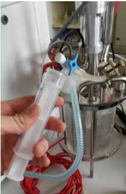
Abb. 5: Mit einer Spritze werden aus dem Fermenter Proben gezogen, um die Dichte der Bakterien zu bestimmen.
