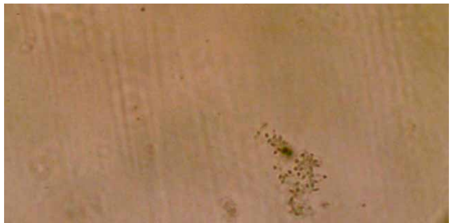
Abb. 7: Polyethylen Folie aus dem Fermenter 2 (Ostseewasser, Polyethylenfolie und A. borkumensis ) mit einem Zellhaufen auf der Oberfläche.
