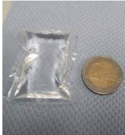
Abb. 13: In der Pouchzelle verwendetes Elektrolytkissen, Referenzgröße 2€ Stück.
