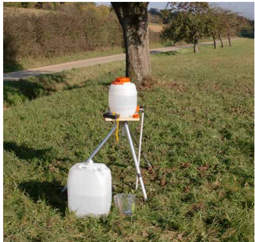
Abb. 7: Aufbau Permeameter im Gelände; a) Prinzipbild b) reale Situation [11] (mit freundlicher Genehmigung von Heinrich Wiltschut, Lügde [4]).
