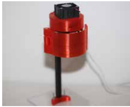
Abb. 6: Messstation mit Ventilator (schwarzer Kasten auf der roten Abdeckung).
