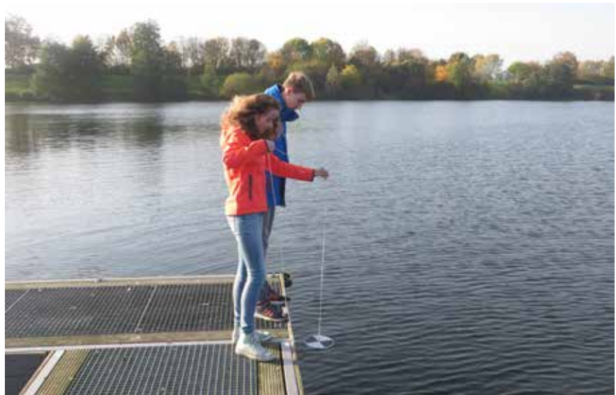
Abb. 5: Bestimmung der Sichttiefe mit der Secchi-Scheibe.
