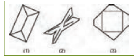
Abb. 1: Kristallstrukturen von Struvit: (1) sargdeckelähnliche (2) dendritische (3) rhombohedrale Struktur.
