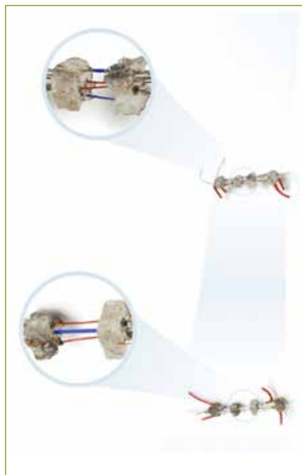
Abb. 6: Weiterentwicklung eines Bewegungsbausteins von einem zu zwei Mitteldrähten (blau)
