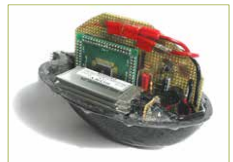
Abb. 13: Innenansicht des Kopfes mit eingebauter Elektronik
