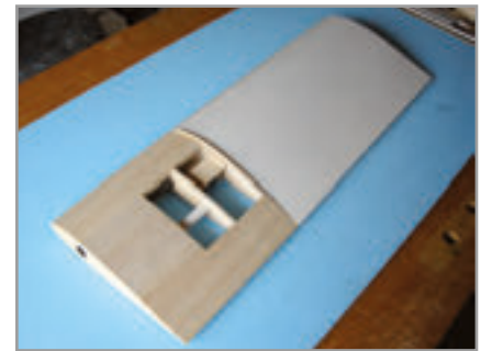
Abb. 7: Rohbau mit Depron
