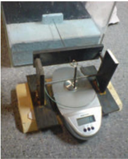
Abb. 6: Bei den ersten Versuchen benutzte ich eine digitale Küchenwaage zur Messung der auftretenden Kräfte. Zu sehen ist der Ablauf der Messung
