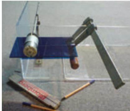
Abb. 3: Montage des Elektromotors auf der blauen Plexiglasplatte und Verbindung der Antriebswelle mit dem Exzenter
