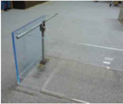
Abb. 2: Eine erste Version des Wellenerzeugers: Eine Exzenterwelle - von einem Elektromotor in Drehung versetzt - hebt und senkt eine Plexiglasplatte
