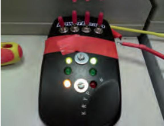
Abb. 5: Erster Prototyp mit Zeitverzögerung und Messbereichswahl
