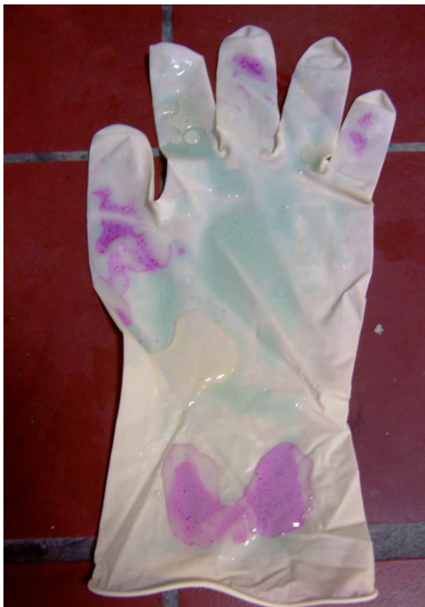
Abb. 3: Der mit Gelatine beschichtete Schutzhandschuh ist in Kontakt mit einer Base und einer Säure gekommen. Verfärbung des Indikators Phenolphthalein nach lila bei Kontakt mit einer Base, Verfärbung des Indikators Bromthymolblau nach gelb bei Kontakt mit einer Säure im Bereich des Handballens.
