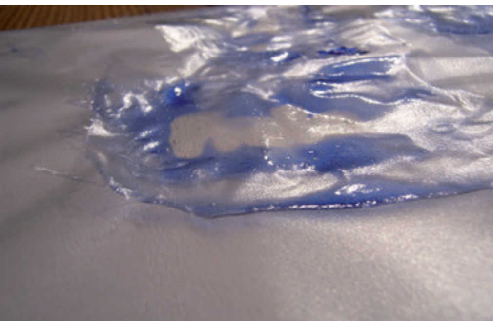
Abb. 2: Der Gelatinefilm löst sich von der Folie
