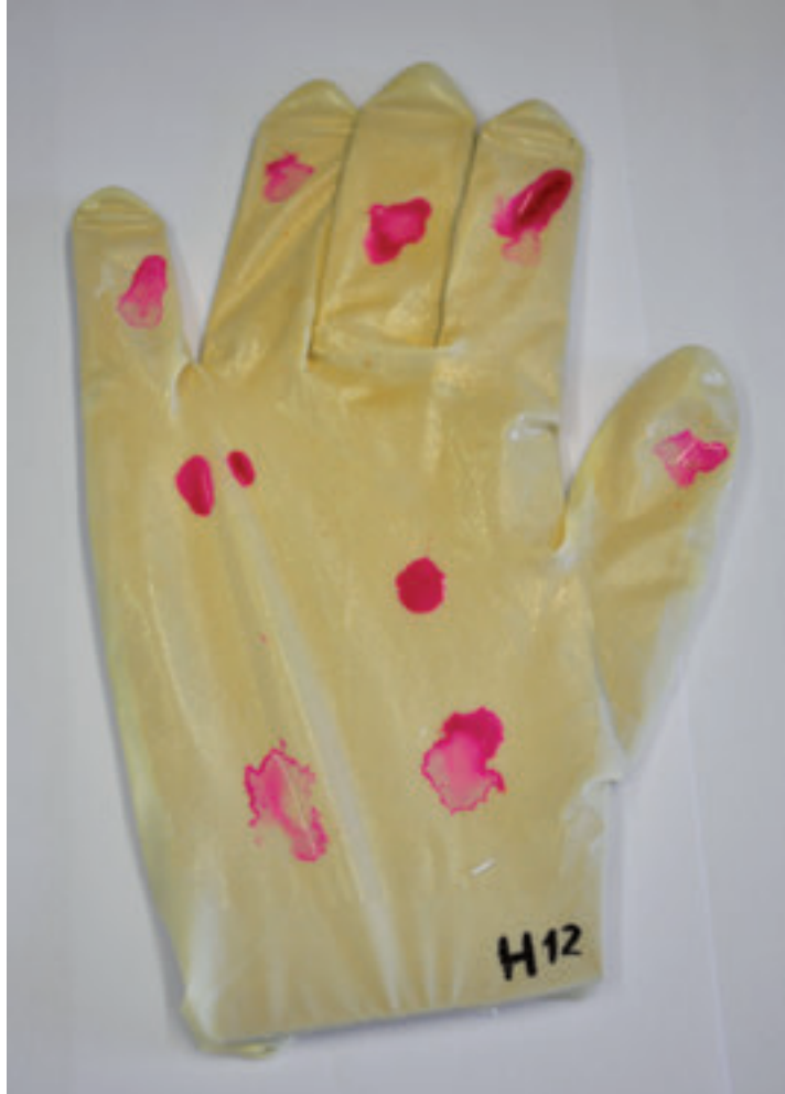
Abb. 4: Handschuh mit Polysilan-Beschichtung nach Kontakt mit Natronlauge
